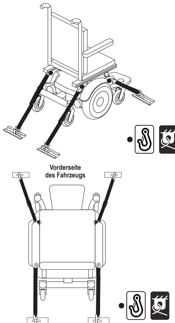
Bild 6. Sicherungspunkte des Befestigungssystems (Transport ohne Rollstuhlfahrer)
