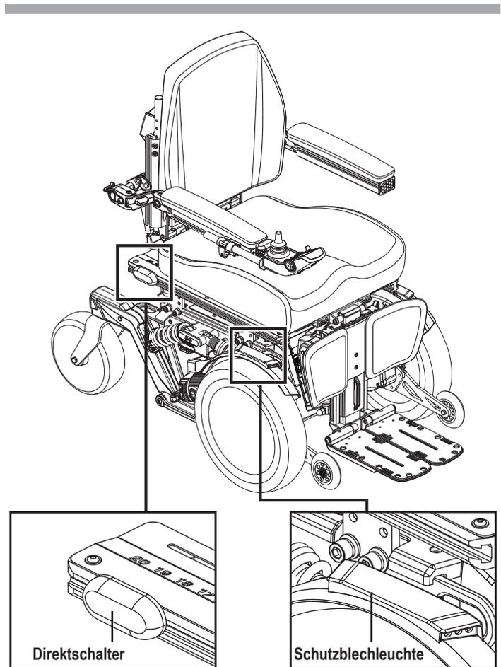
**Bild 3.** Quantum 4Front Serie mit Direktschalter zur Bedienung der Schutzblechleuchten
