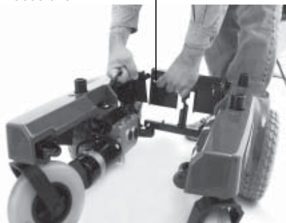
Figura 19. Rimozione del telaio anteriore
