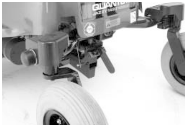
Figura 5. Disinnescamento della trazione
