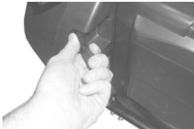
Figura 8. Impugnatura corretta della leva sblocco ruote manuale
