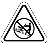
**Non posizionare la carrozzina in modalità di sblocco ruote in pendenza.**
