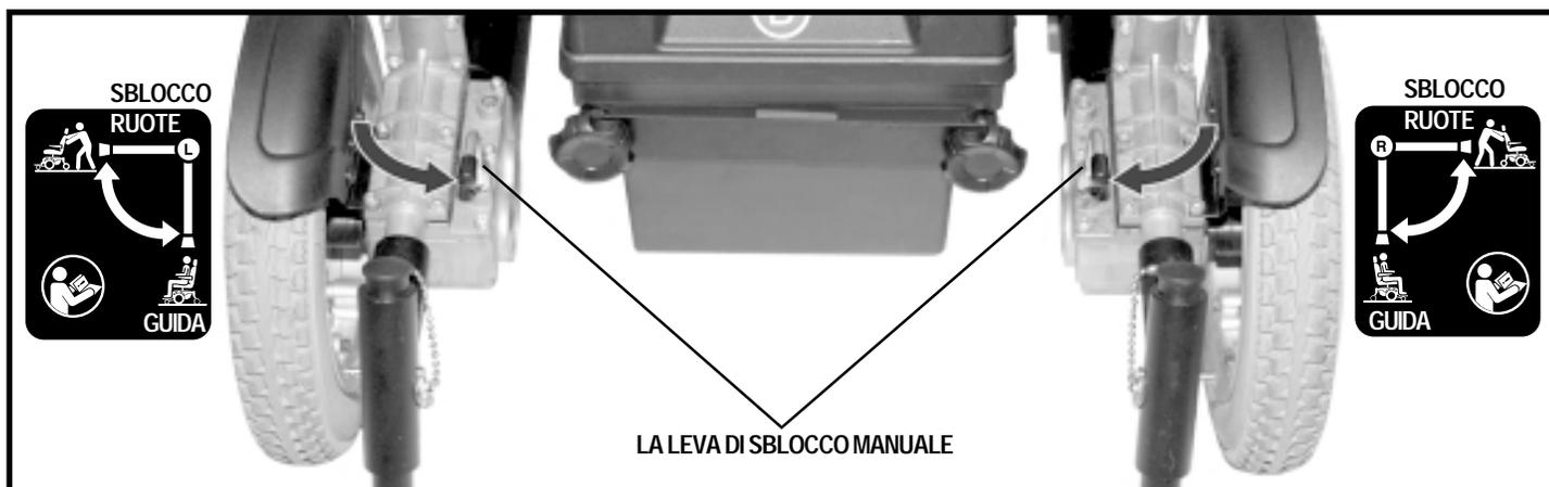
Figura 11. Modalità di guida (Trazione attivata)
