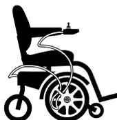
**Fissare correttamente il cavo della centralina onde evitare che possa incastrarsi nelle ruote, nel telaio o che si possa danneggiare nel passaggio attraverso le porte.**
