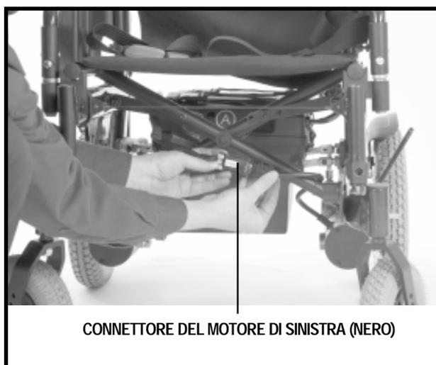
Figura 7. Collegamento del motore (motore sinistro in figura)
