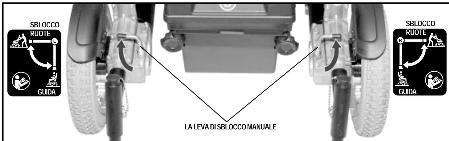
Figura 10. Modalità di sblocco ruote (Trazione disattivata)
