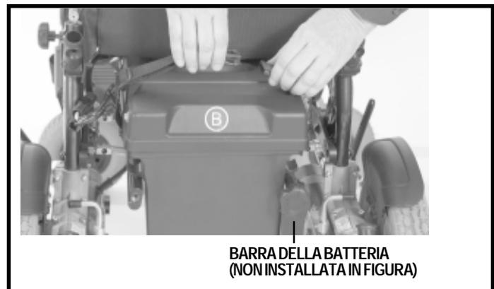
Figura 16. Installazione del telaio batterie
