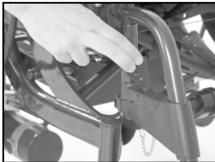
Figura 20. Installazione delle pedaline
