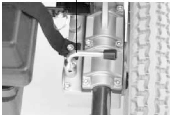
Figura 17. Motori disinnescati (modalità sblocco freni manuale)
