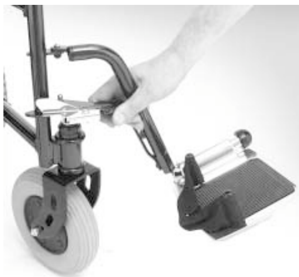
Figura 8. Installazione delle pedaline
