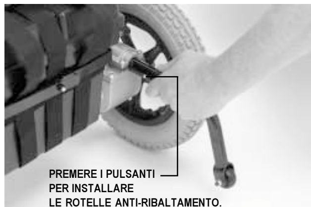
Figura 9. Installazione delle rotelle anti-ribaltamento
