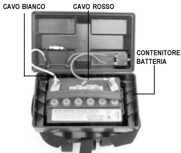
Figura 2. Installazione di una batteria
