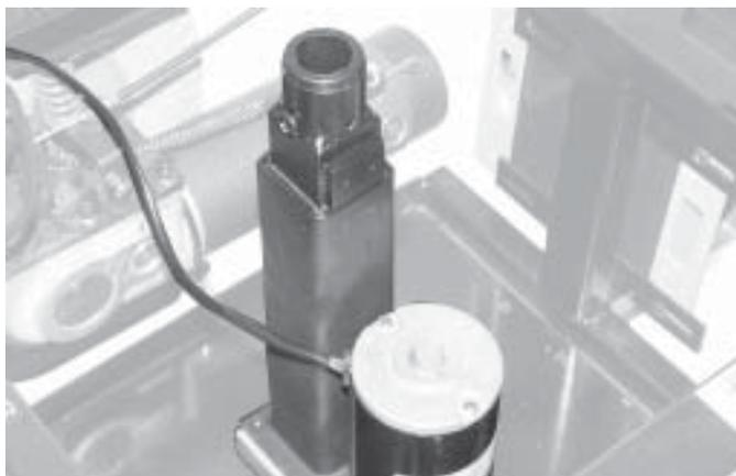
Figura 18. Pulsador del asiento de elevación eléctrica
