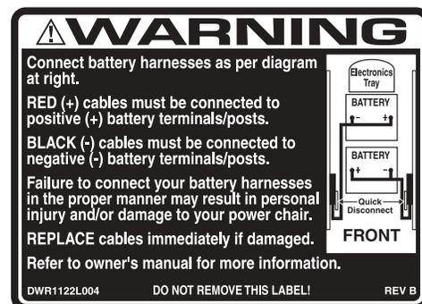
Figura 28. Etiqueta con el diagrama de cableado de la batería (1101/1121)
