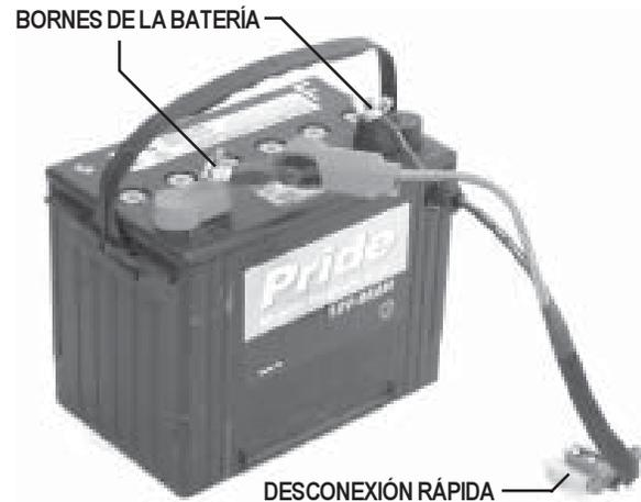
Figura 27. Batería y cableado eléctrico
