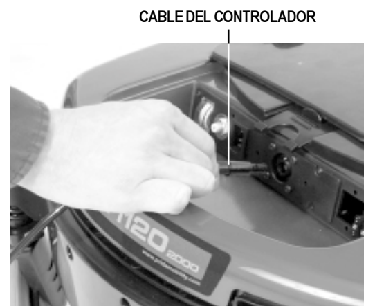
Figura 11. Conexión del Cable del Controlador
