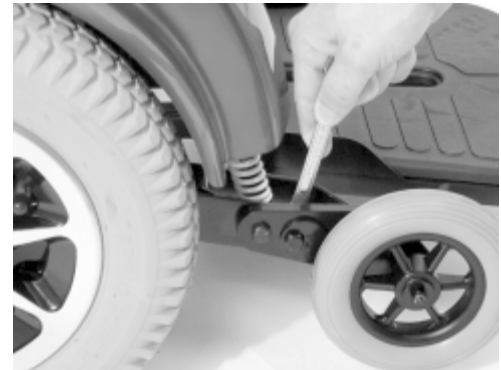
Figura 29. Ajuste de las Ruedas Contra Volteo
