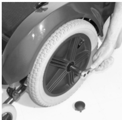
Figura 31. Removido de la Tuerca de la Rueda
