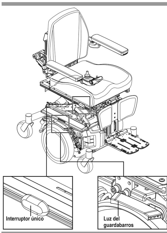
Figura 4. Interruptor único para operar las luces del guardabarros
