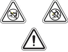
**¡ADVERTENCIA! ¡No utilice la silla eléctrica con los motores desactivados! No utilice el modo manual en las pendientes, ya que la silla podría rodar descontroladamente. Utilice el modo manual únicamente sobre superficies planas.**
