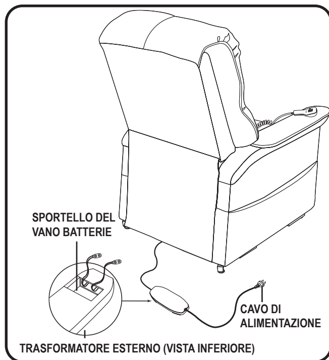
Figure 4.2 Ubicazione delle batterie di back-up della poltrona elevabile
