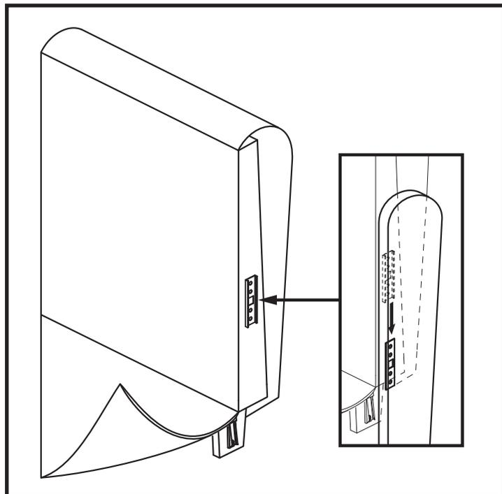
Figura 3. Installazione della guida a scorrimento
