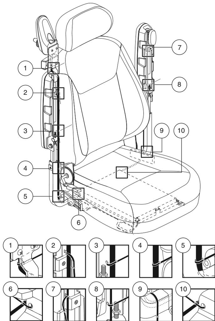
Figure 10. Câble sécurisé sur un siège avec iLevel
