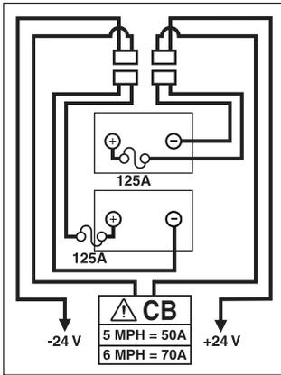
Diagramma de câblage des batteries
