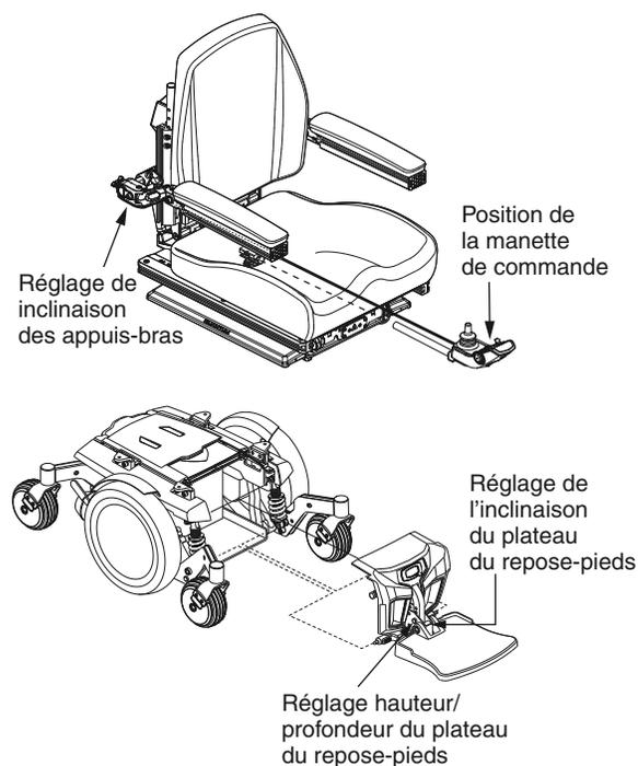
Figure 5. Vue de l'assemblage du fauteuil
