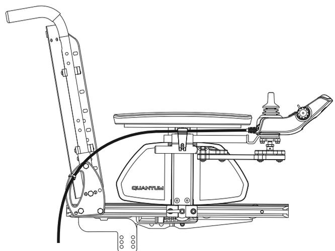
Figure 9. Câble sécurisé sur un siège TB-Flex
