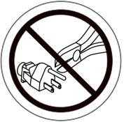
**Il est dangereux d'enlever la fiche de mise à la terre du cordon d'alimentation. Au besoin, faites installer une prise murale à 3 fentes ou utilisez un adaptateur à 3 fiches approuvé.**
