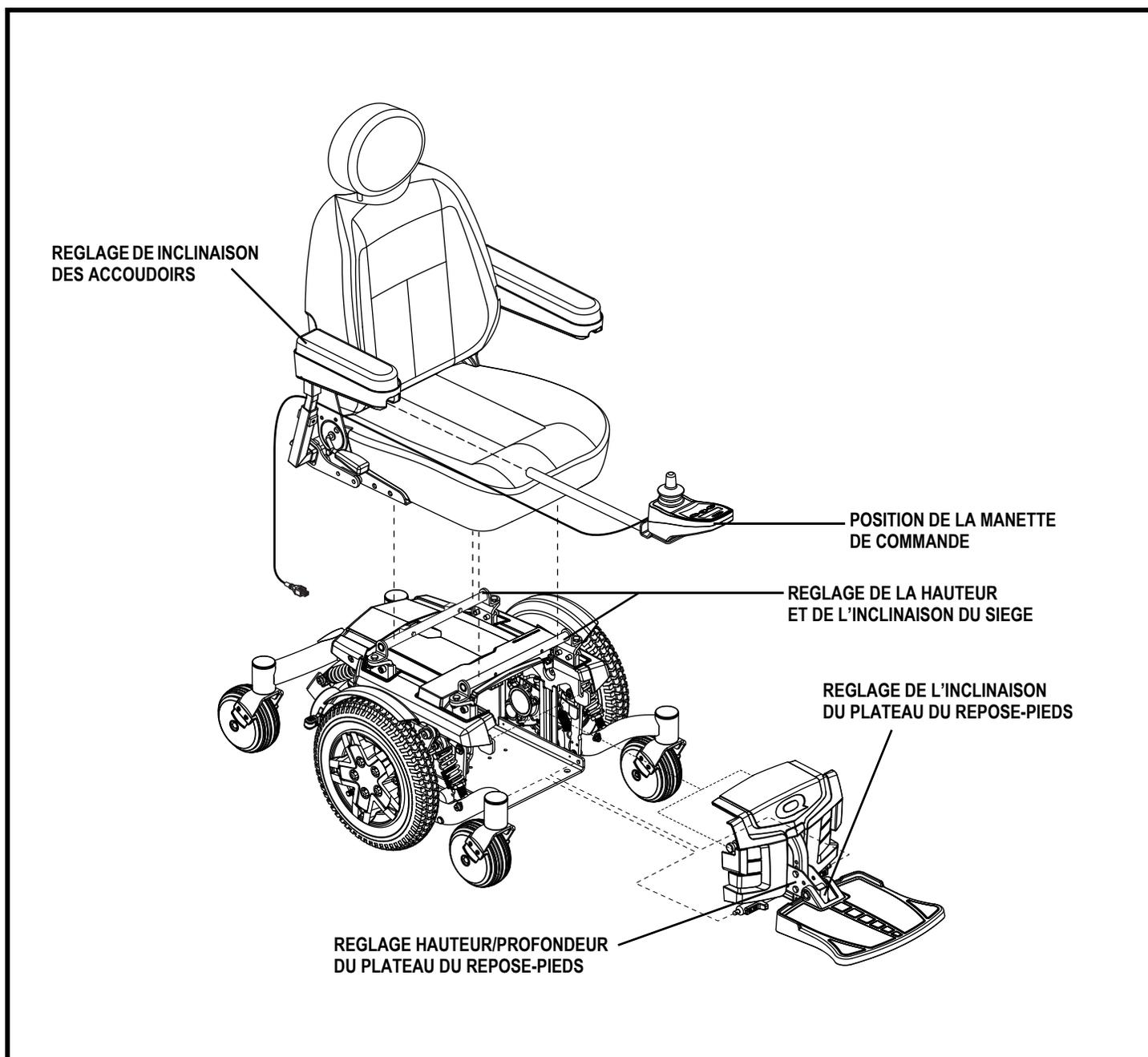
Figure 9. Vue de l'assemblage du fauteuil Q6 Edge HD
