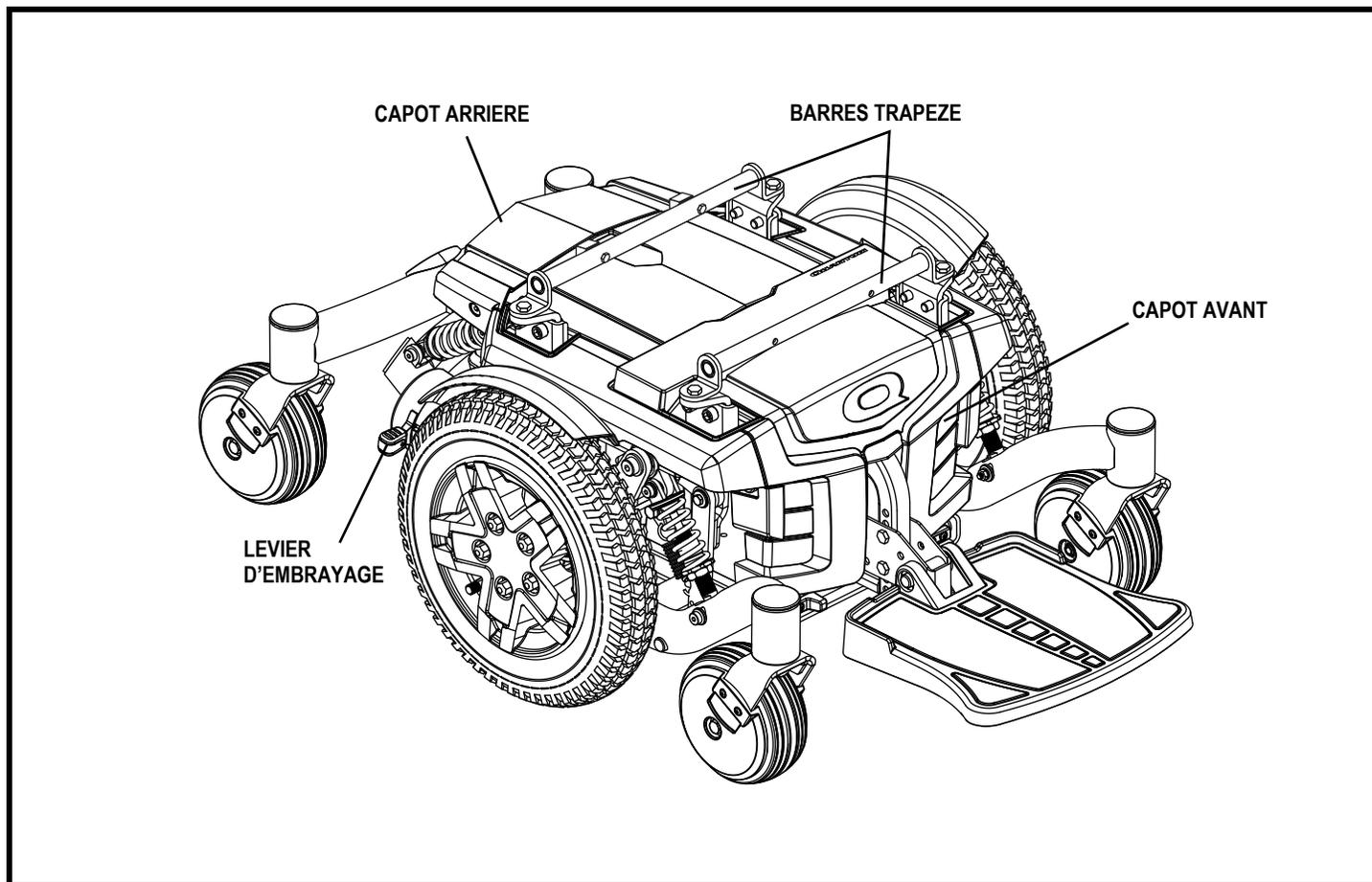
Figure 5. Base motorisée du Q6 Edge HD
