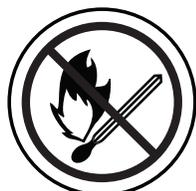
**Indique que ce matériau est inflammable. Ne l'exposez pas à une source de chaleur, à une flamme ou à des étincelles. Ne transportez pas les batteries en compagnie de matériau inflammable ou des combustibles.**
