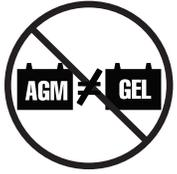
**Ne coupez pas une batterie de type "AGM" avec une de type "Gel-Cell". Utilisez toujours deux batteries du même type chimique.**
