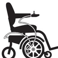
**Attachez correctement le câble du contrôleur afin d'éviter que celui-ci ne se coince dans les roues, dans le cadre du siège ou qu'il ne s'accroche lorsque vous passez le cadre d'une porte.**
