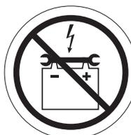
**Tenez les outils et autres objets en métal loin des bornes des batteries. Un contact avec un outil en métal peut provoquer un choc électrique.**
