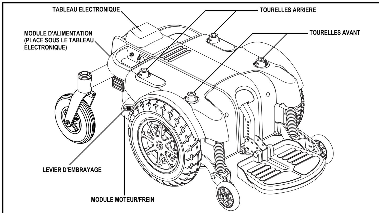
Figure 6. Base motorisée du Quantum 1121
