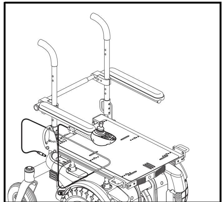
Figure 12. Emplacement du câble du module de contrôle sur un Siège Synergy
