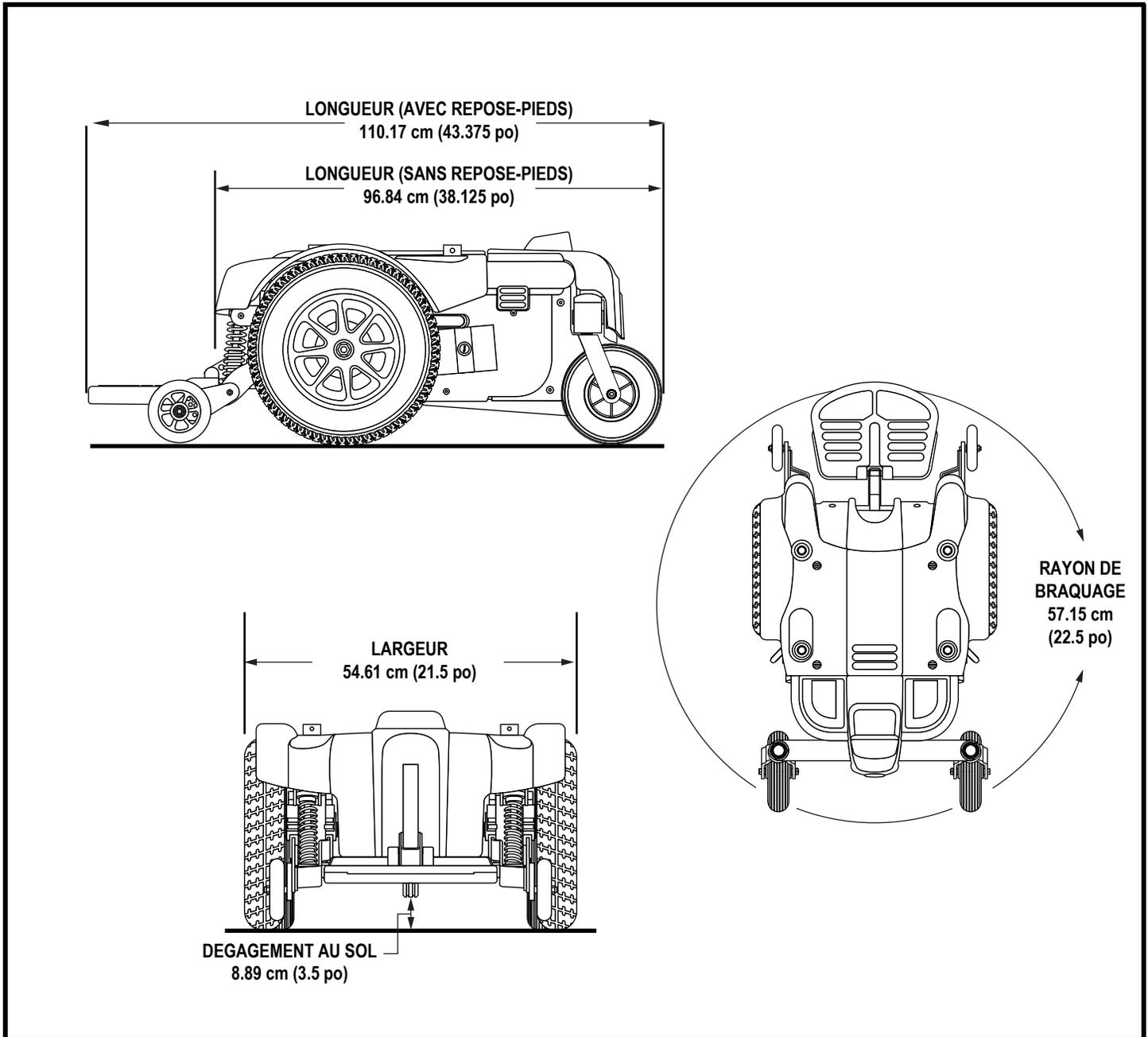
Figure 26. Dimensions et dégagement au sol Quantum 1121
