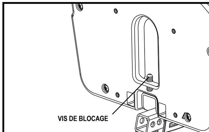
Figure 19. Réglages de l'inclinaison du repose-pieds
