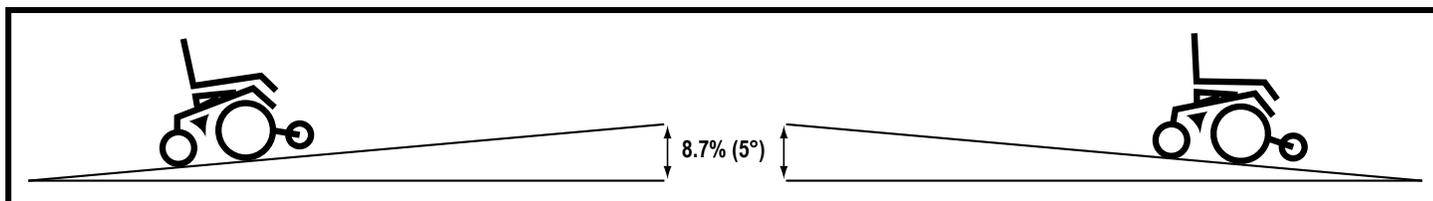
Figure 1. Montée/Descente maximale
