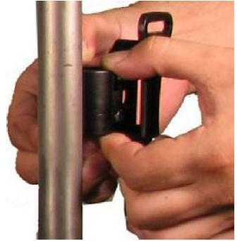
5. Fixer la quincaillerie de montage 2 Point PRO aux montants arrière du fauteuil roulant. La quincaillerie de montage devrait avoir la même hauteur sur les côtés gauche et droit, et être parallèle au cadre du fauteuil.
