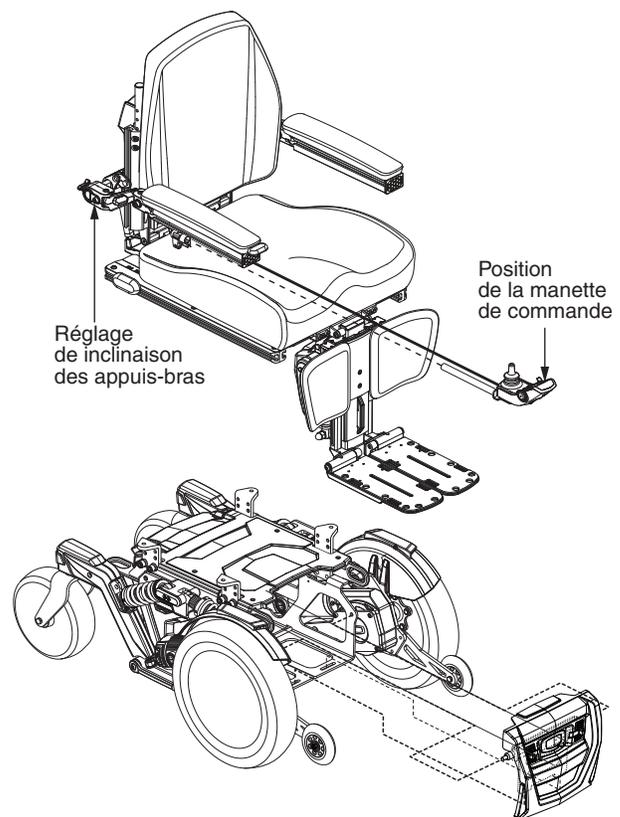
Figure 4. Vue de l'assemblage du fauteuil Quantum 4Front
