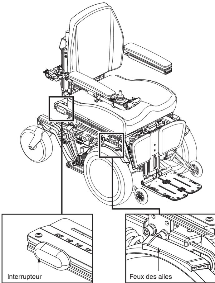
Figure 3. Quantum 4Front avec interrupteur simple pour allumer les feux des ailes
