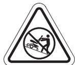
**Non posizionare la Carrozzina in modalità di sblocco ruote in pendenza.**
