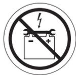
**Allontanare strumenti ed oggetti metallici dai terminali della batteria. Il contatto con attrezzi può provocare scosse elettriche.**
