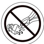
**La rimozione dello spinotto di messa a terra può causare scossa elettrica. Se necessario, installare correttamente un adattatore autorizzato a 3 spinotti in una presa elettrica con accesso per spina a 2 spinotti.**
