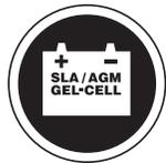
**Per ridurre il rischio di perdite di liquido o condizioni di esplosione, usare solamente batterie AGM o gel.**
