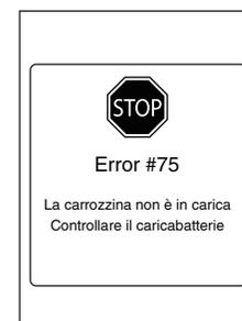
Figura 10. Q-Logic 3 indicatore di carica della batterie
