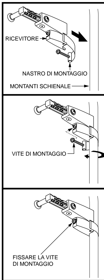
Figura 4. Installazione supporto di montaggio su tubi solidi
