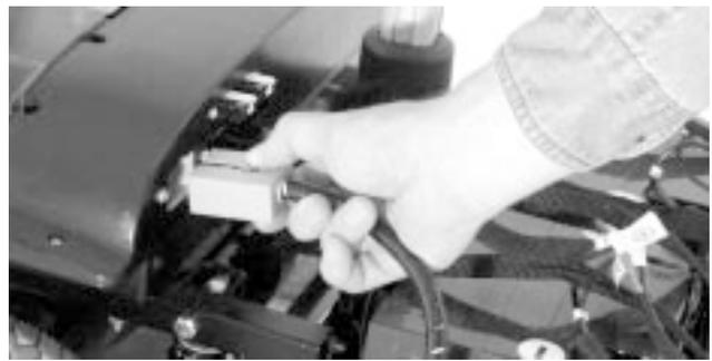
FIGURE 21. DISCONNECTING THE FRONT-TO-REAR HARNESS
