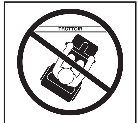
Figure 7. Approche incorrecte de trottoir
