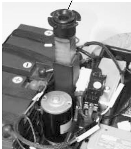
FIGURE 17. ÉLEVATEUR ÉLECTRIQUE (OPTIONNEL)
