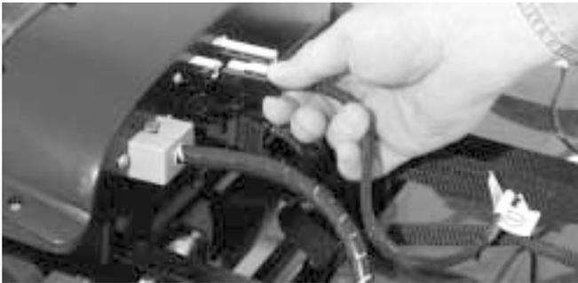
FIGURE 20. DÉBRANCHEMENT DES BATTERIES
