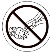
**Il est dangereux d'enlever la fiche de mise à la terre du cordon d'alimentation. Au besoin, faites installer une prise murale à 3 fentes ou utilisez un adaptateur à 3 fiches approuvé.**
