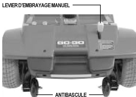
Figure 6. Section arrière
