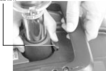
Figure 13. Fermoir du module de batteries
