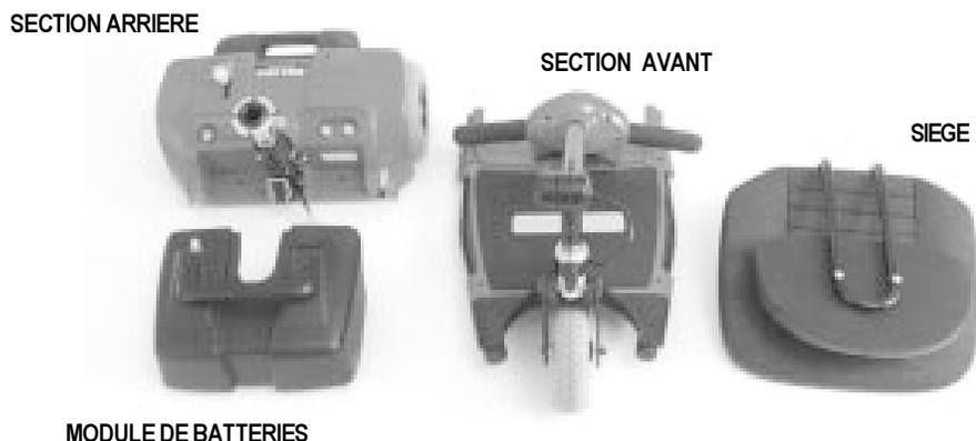
Figure 11. Scooter démonté
