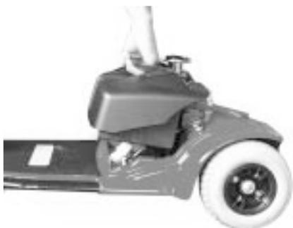
Figure 14. Soulèvement du module de batteries
