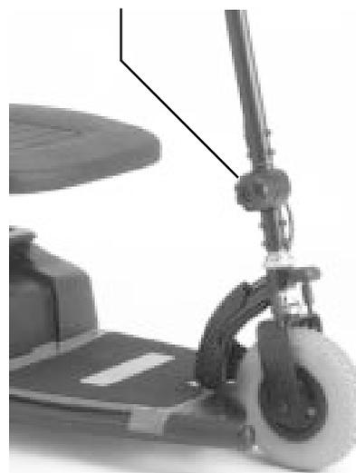
Figure 9. Réglage du guidon
