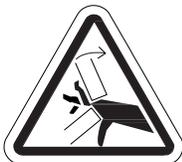
**Points de pincement ou d'écrasement créés lors de l'assemblage et (ou) du fonctionnement. Maintenez les mains et les doigts à l'écart des composants mécaniques lors du fonctionnement.**
