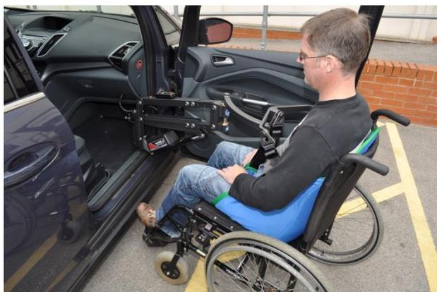
5. Abaissez la personne pour l'asseoir sur le siège extérieur. Soulevez-la en utilisant la sangle arrière de l'élingue pour l'amener plus facilement à une bonne position assise.
