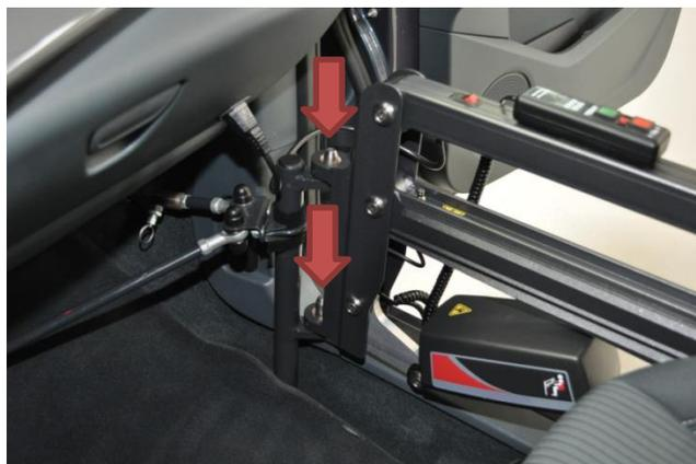
1. Assemblez le bras de levage, la rallonge et la barre d'écartement. Reposez l'ergot inférieur de fixation contre la broche inférieure (longue) avant d'aligner la broche supérieure. Le bras doit se positionner en douceur, en glissant. Mettez le monte-personne en circuit.
