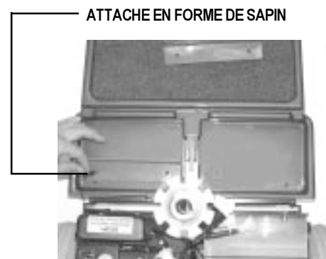
Figure 8a. Installation des attaches en forme de sapin
