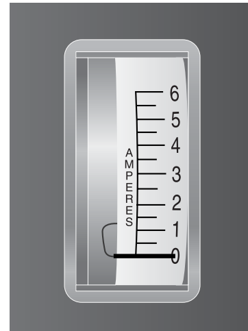
Figure 8. Ampèremètre indiquant des batteries entièrement chargées
