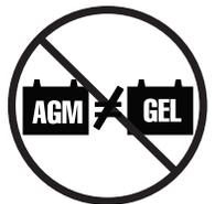
**Ne coupez pas une batterie de type "AGM" avec une de type "Gel-Cell". Utilisez toujours deux batteries du même type chimique.**
