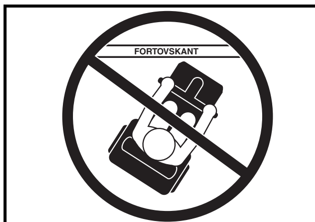
Figur 3A. Forkert tilgang til fortovskant
