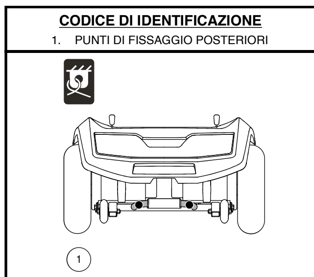
Figura 10. 710ZT - Punti di fissaggio (Identificati dai punti neri)
