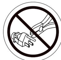
**Verwijdering van de aarding tak kan een elektrisch gevaar scheppen. Als het nodig is, monteer een toegestane driestand adapter naar een stopcontact met een tweestand stekker toegang. Verzuim kan persoonlijk letsel en/of gereedschap schade veroorzaken.**
