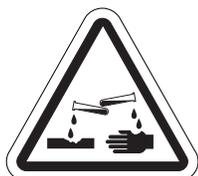
**Batterijen bevatten corrosieve chemicaliën. Gebruik alleen AGM of Gel-Cell batterijen om het risico van lekken of explosies te verminderen.**
