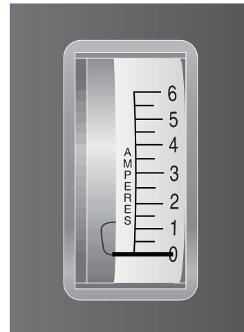
Figuur 9. Amperemeter geeft aan dat de batterijen volledig zijn geladen
