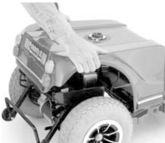
La Figure 16. Démontage d'Enveloppe de Protection
