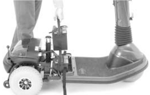
La Figure 24. Démontage de Batterie
