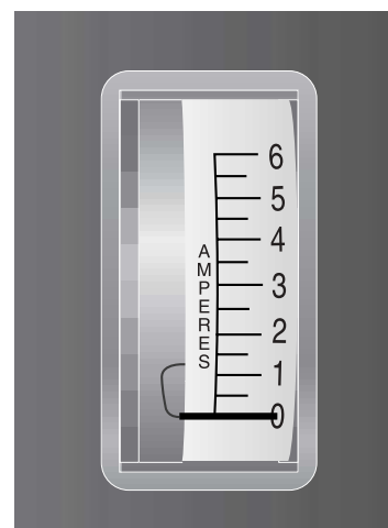
Figure 8. Ampèremètre (batteries complètement chargées)
