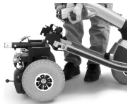
Figure 20. Séparation des sections du cadre
