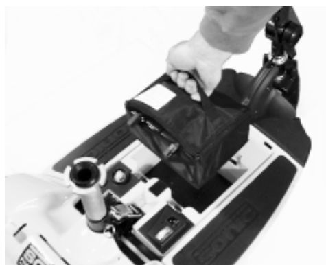
Figure 11A. Enlèvement du module de batteries
