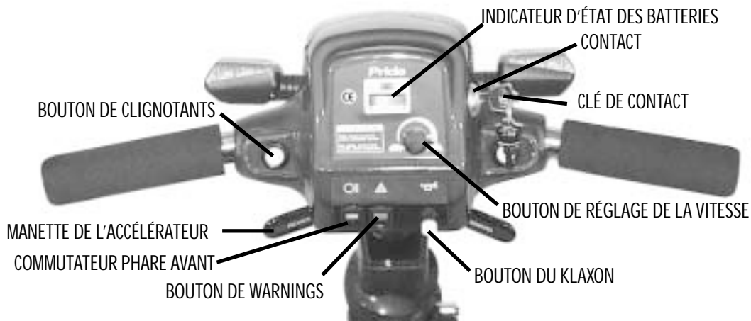
FIG. 7 CONTROLE DE LA CONSOLE
