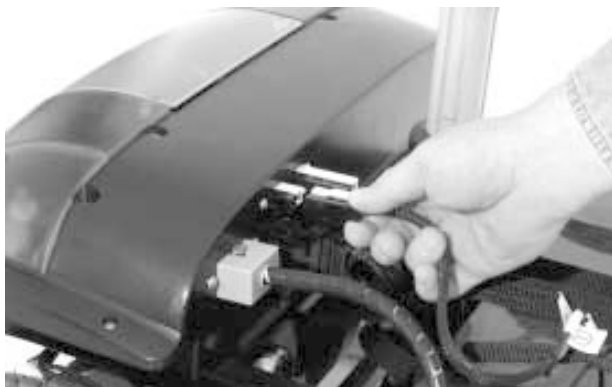
Bild 23. Ausstecken des Batterieverbindingsgeschirr
