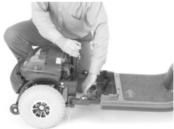
Bild 28. Trennung der Rahmenteile
