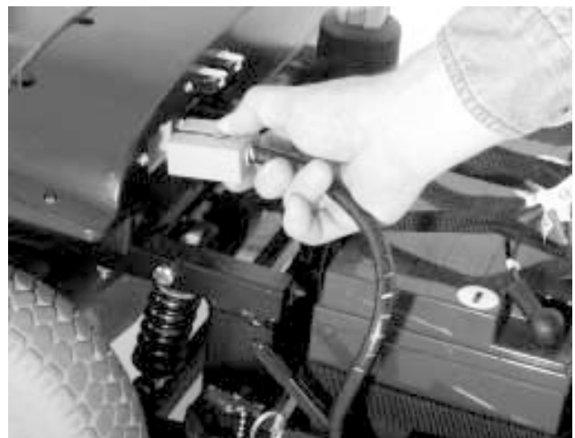
Bild 22. Ausstecken des Verbindungskabelgeschirr
