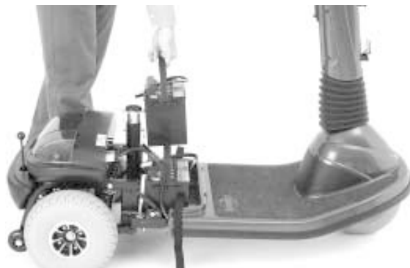
Bild 24. Abnahme der Batterie
