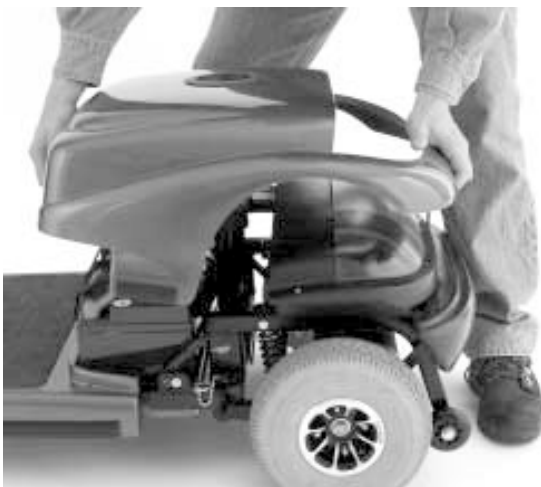
Bild 21. Abnahme des hinteren Gehaeuse
