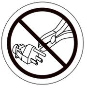
**Das Entfernen des Erdungsstiftes kann zu elektrischer Gefährdung führen. Wenn notwendig, installieren Sie einen zugelassenen 3-poligen Adapter an einen elektrischen Ausgang mit einer 2-poligen Steckdose.**
