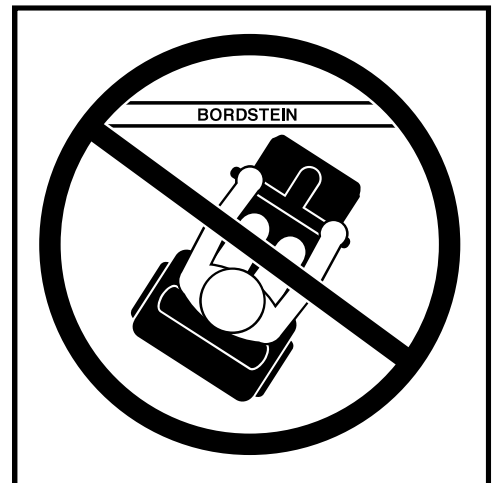
Abb. 7. Falsches Anfahren eines Bordsteins
