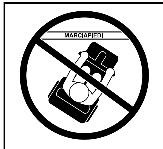
Figura 7. Approccio errato al marciapiede
