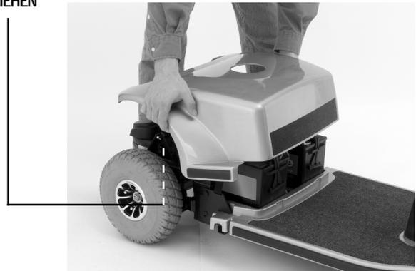
Abb. 15. Abbau der Heckteilabdeckung
