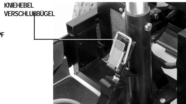
Abb 19. Kniehebelschluß (auf)
