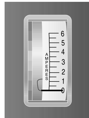
Abb. 8. Amperemeter (zeigt Vollgeladene Batterien an)
