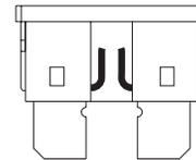
Abb. 22. Durchgebrannte Sicherung (auswechseln)
