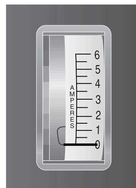
Abb 8. Amperemeter (zeigt Vollgeladene Batterien an)
