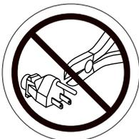
**Das Entfernen des Erdungsstiftes kann zu elektrischer Gefährdung führen. Wenn notwendig, installieren Sie einen zugelassenen 3-poligen Adapter an einen elektrischen Ausgang mit einer 2-poligen Steckdose. Fehler in der Beachtung dieser Anweisung können zu Personenschaden und/ oder Beschädigung des Gerätes führen.**
