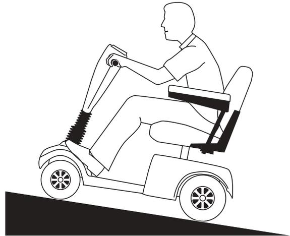
Abb. 2A. Fahrstellung für Erhöhte Stabilität
