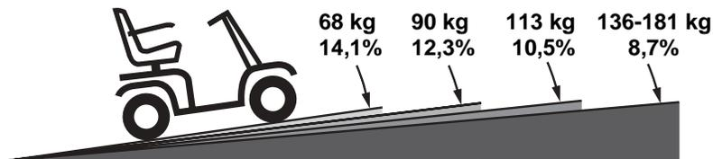
Abbildung 1. Empfohlene maximale Steigungswinkel
