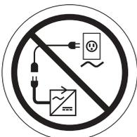
**Verhindern Sie Personenschaden oder Beschädigung des Geräts. Verbinden Sie kein Verlängerungskabel an den Wechselstrom-/ Gleichstromwandler oder das Batterieladegerät.**
