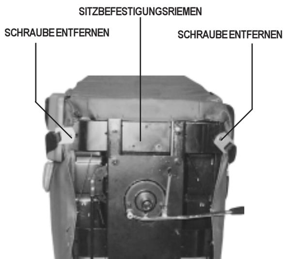
Abb 14. Einbau des Ruckhaltegurtes
