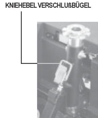
Abbildung 17B. Kniehebelverschluss gesichert.
