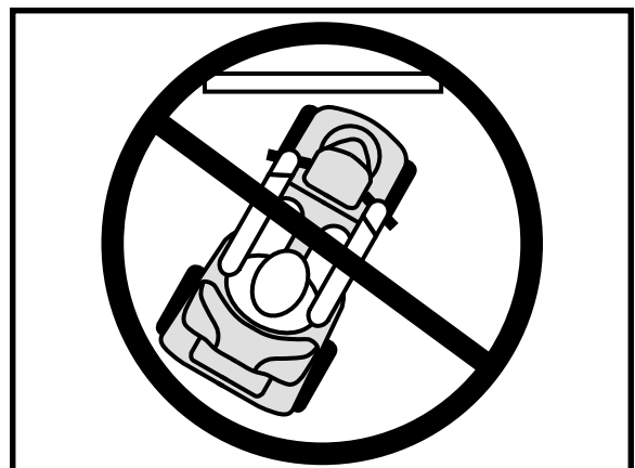
Abb. 3A. Falsches Anfahren einer Bordsteinkante
