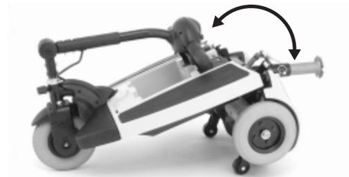
Abb. 20. Positionierung des Rahmens
