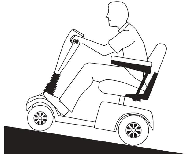
Abb. 2a. Fahrstellung für Höhere Stabilität
