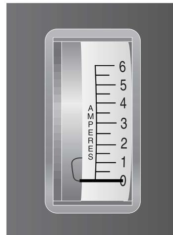
Abb. 8a. Amperemeter Zeigt Vollgeladene Batterien an
