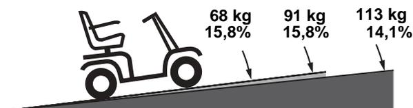
Abb. 1. Maximal Empfohlene Steigungswinkel für den Sonic
