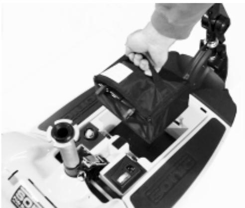
Abb. 11a. Batteriepack Entfernen
