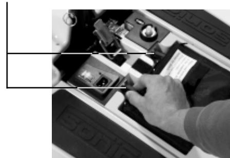
Abb. 11. Trennen der Batterieverbindungsstecker
