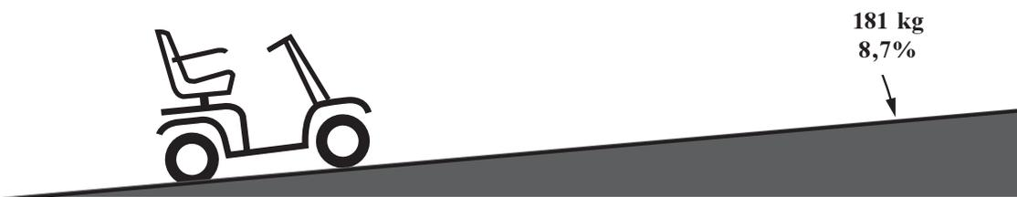
Abb. 1. Maximal empfohlene Steigung
