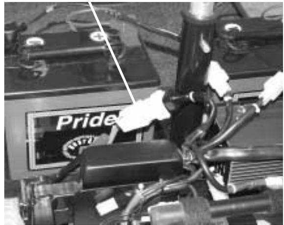
Abbildung 15. Verbindungsstecker hauptkabelbaum
