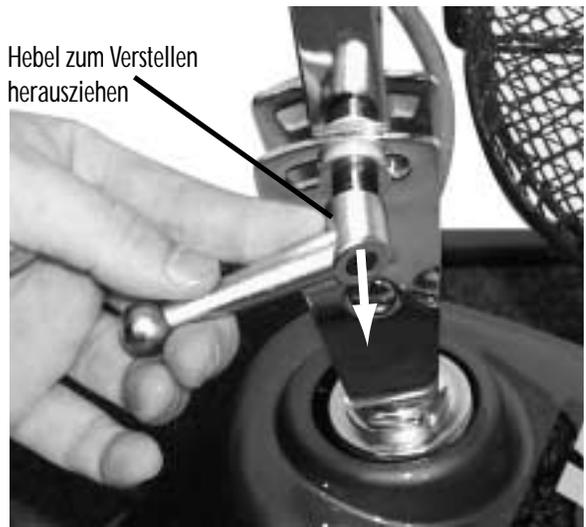
Abbildung 9b. Betätigung der Knebelschraube
